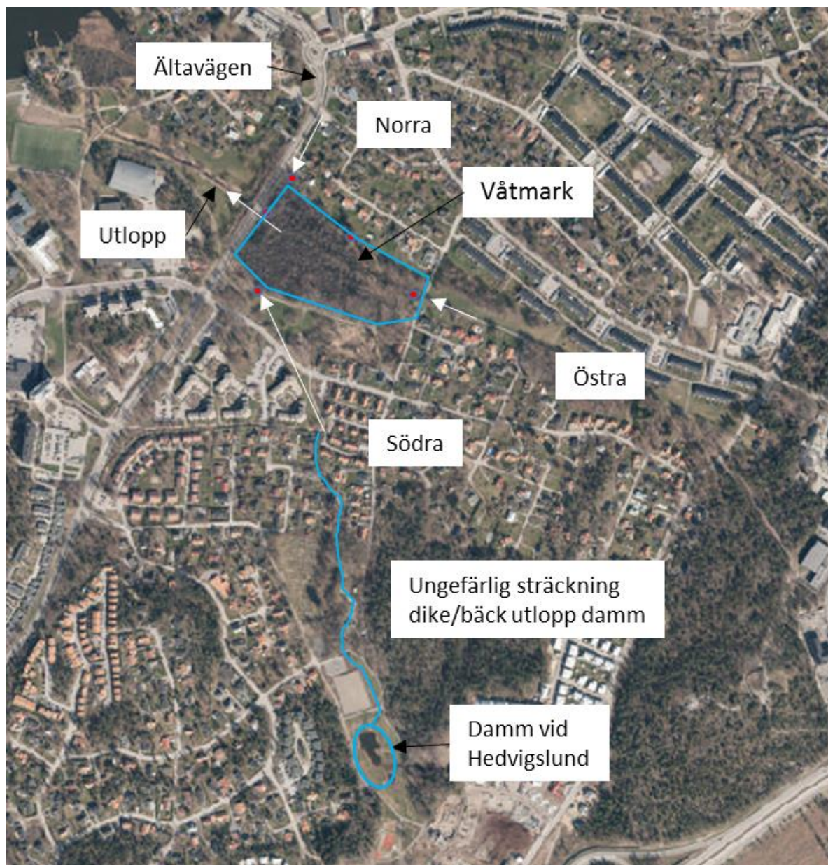
Figur 4:1. Flygfoto över våtmarken och området runtomkring. De tre delavrinningsområdena benämns norra, östra och södra. De mynnar i våtmarken vid de röda prickarna och flödesriktningen markeras med vita pilar ytterligare beskrivning i avsnitt 5.4.1.
